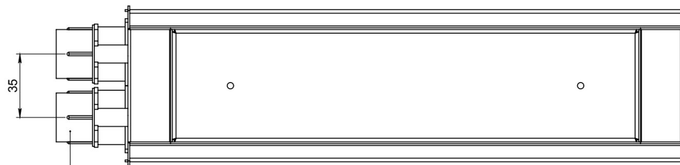
Spelsberg Rohrkapsel - für Rohrtyp M20 - Rohr-Aussen-Ø 20mm
